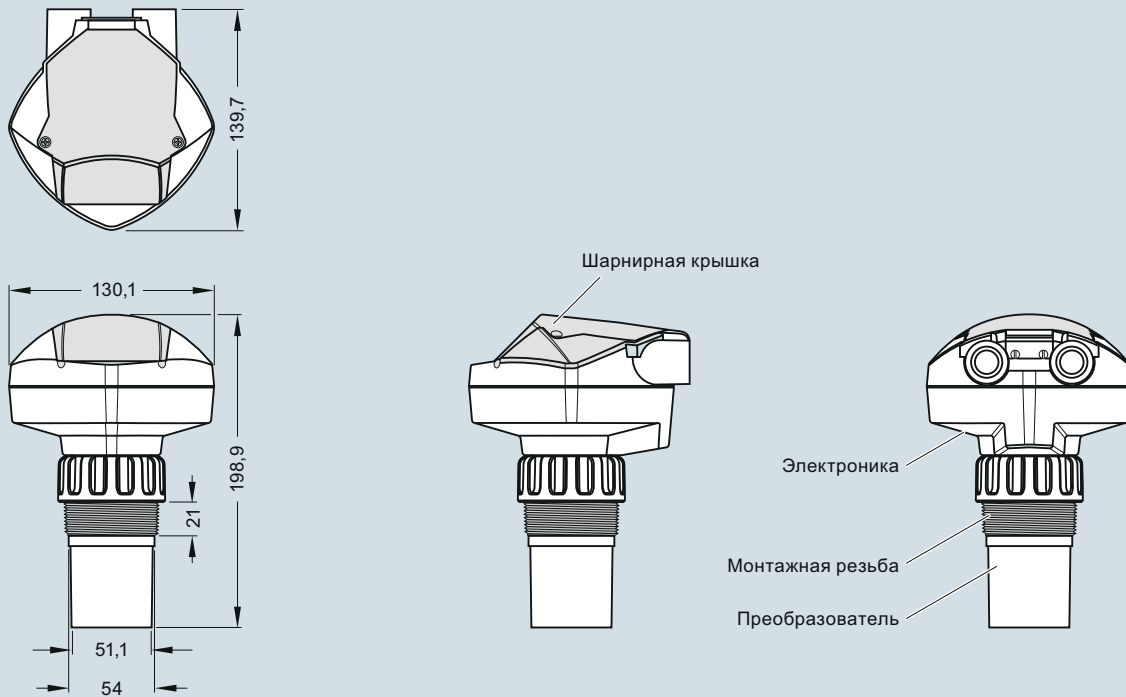
SITRANS Probe LU, размеры в мм
